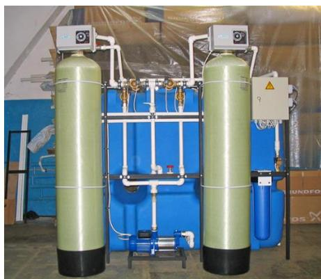
Исходная вода по давлению 2-3 бар (но не более 3 бар) и объемной подачей не более 4 м<sup>3</sup>/час подается по трубопроводу 1 1/4", на котором смонтирован насос-дозатор подающий в воду раствор алюмокремниевый коагулянт-флокулянт (АКФК)
