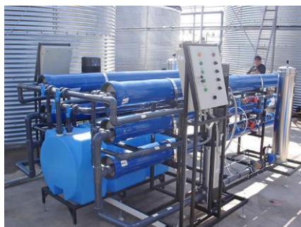
Мембранная система очистки воды производительностью 20 м³/час
